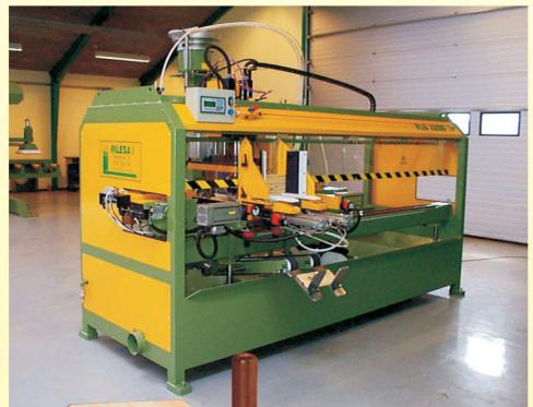
Eine der optionalen Zusatzausrüstungen für die VLGD2200 ist die Ablängsäge auf einer nachfolgenden Seite, welche am Einlauf der Maschine aufgebaut werden kann
