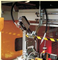
Eines der Zusatzausrüstungen für die VLG- und UNI-X Serien ist die 45° Grad Bohreinheit.
