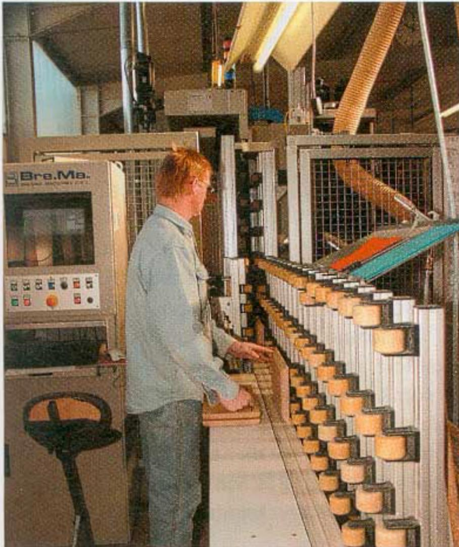
**Kleinere Teile können paarweise bearbeitet und durch die Maschine geschleust werden**
